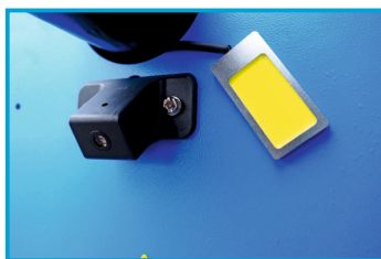
WSKAŹNIK LASEROWY ORAZ OŚWIETLENIE WNĘTRZA KOŁA
