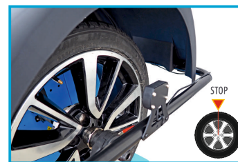
AUTOMATYCZNE POZYCJONOWANIE KOŁA W MIEJSCU NIETYWAŻENIA
