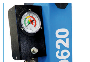
Metalowa skrzynka z manometrem
