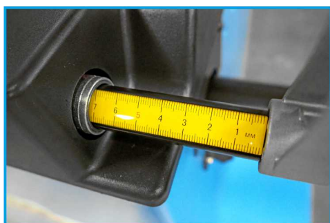
PRECYZYJNE I AUTOMATYCZNE RAMIĘ POMIAROWE
