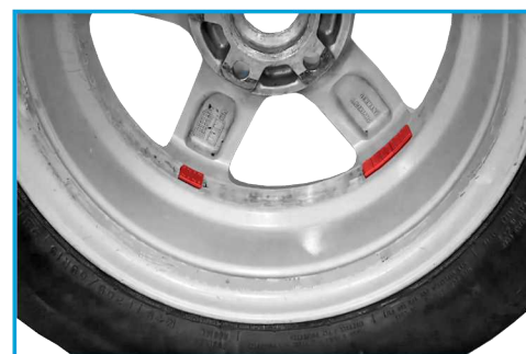
FUNKCJA UKRYWANIA CIĘŻARKÓW ZA RAMIONAMI!
