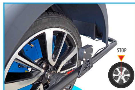
AUTOMATYCZNE POZYCJONOWANIE KOŁA W MIEJSCU NIETYWAŻENIA
