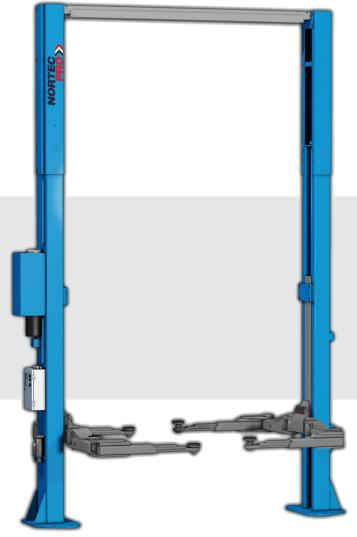
8000 kg CAPACITY: 400V/50Hz POWER SUPPLY: 3,5 kW MOTOR POWER: LIFTING HEIGHT: 120 - 2165 mm TOTAL HEIGHT: 5850 mm **CLEARANCE:** 2862 mm 770 -1800 mm 2-STAGE ARMS: OIL PRESSURE: 25 MPa <75 dB NOISE LEVEL: WEIGHT: 2065 kg
