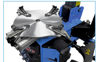
Profilowany stół montażowy od 10" do 24"
