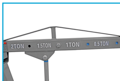
ZMIENNA DŁUGOŚĆ RAMIENIA 950 mm - 1490 mm
