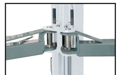
AUTOMATYCZNA BLOKADA RAMION PODCZAS PODNOSZENIA
